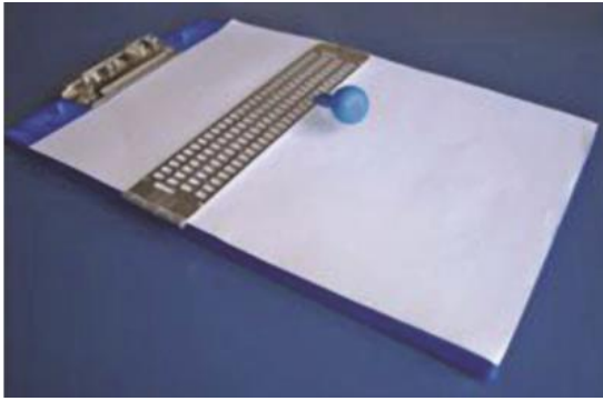
Figura 34 - Prancha de plástico com uma reglete de metal e uma punção azul (Domingues et al.,2010:49).
