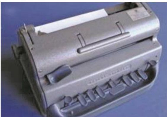
Figura 35 - Máquina de escrever em Braille mecânica na cor cinza (Domingues et al.,2010:49).
