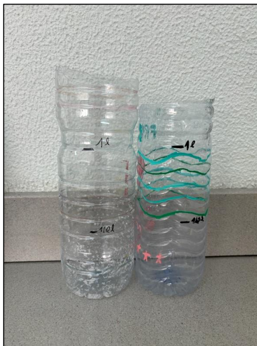
Figura 3 - Medidor elaborado com garrafas de plástico
